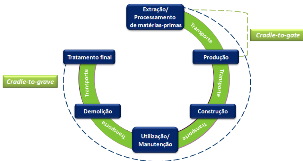
Figura 4 - Ciclo de vida de um material de construção (Fonte: Almeida et al, 2014)
